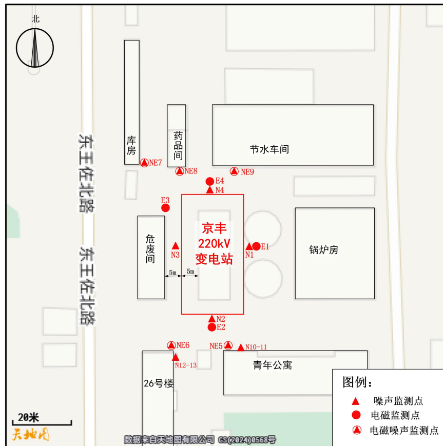
图3-1 变电站周边噪声和电磁监测布点示意图
