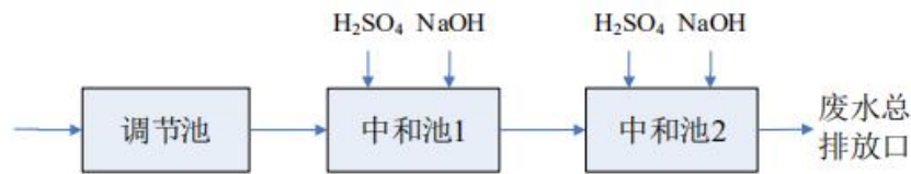
图 4-4 酸碱废水处理系统工艺流程图
