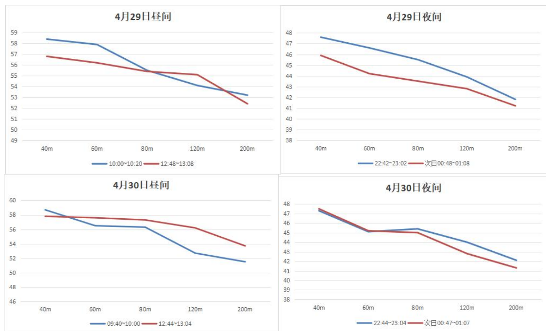
图 8.3 衰减断面噪声值随距离衰减情况
