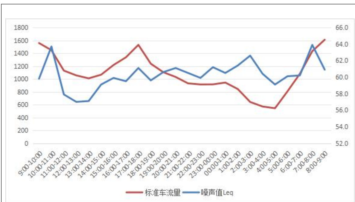
图 8.2 24h 噪声监测结果和车流量随时间的变化趋势分析图
