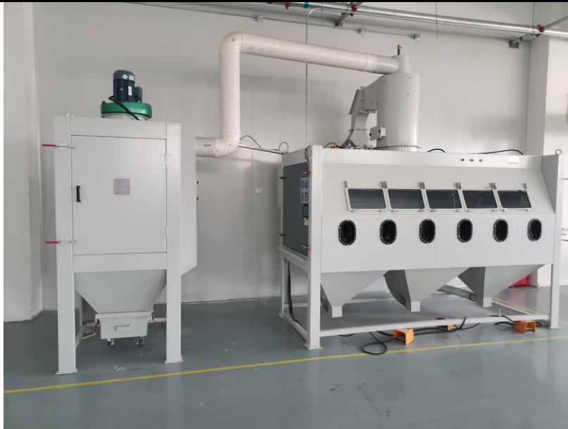
图 8 喷砂设备和自带的除尘设备
