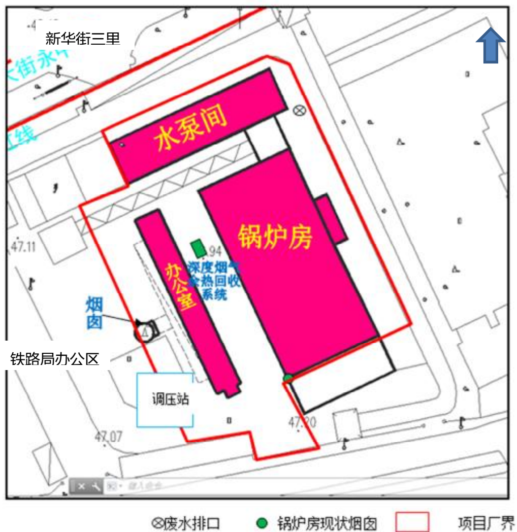
图 3 锅炉房周边关系及锅炉房布置图
