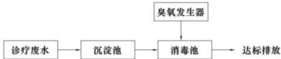
图9 本项目污水处理工艺流程图
