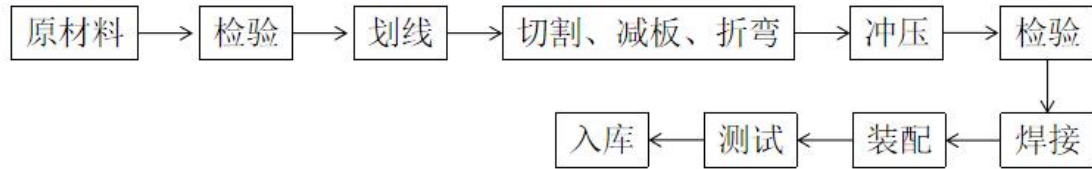
图 4-8 装备制造工艺流程图
