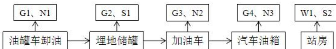
图 4-6 中国石油加油站工艺流程图
