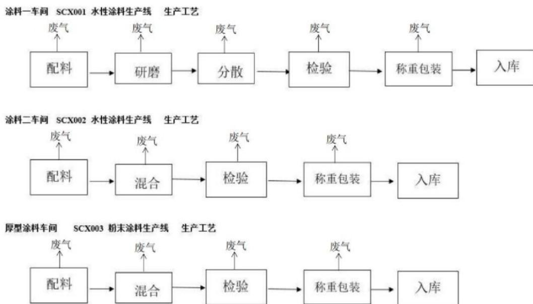
图 4-12 防火材料生产工艺流程图
