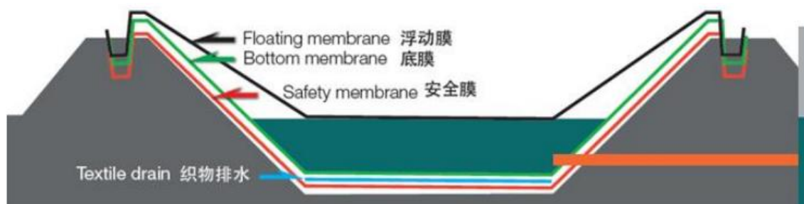
图 3.2-7 厌氧存储塘示意图
