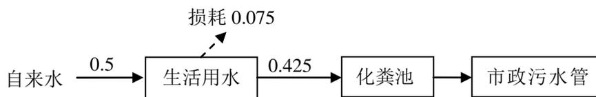
图 2-1 项目水平衡图（单位：m<sup>3</sup>/d）
