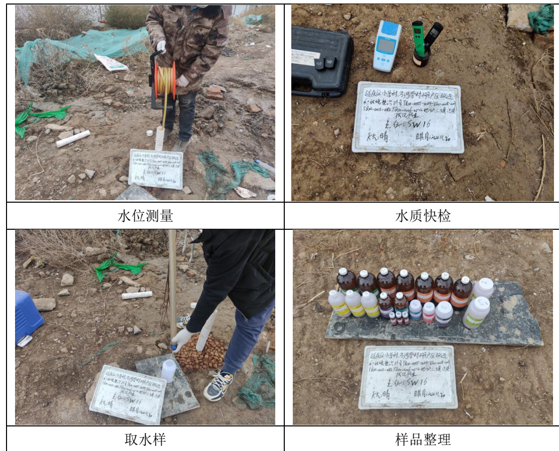
图 5-6 地下水采样全过程照片
