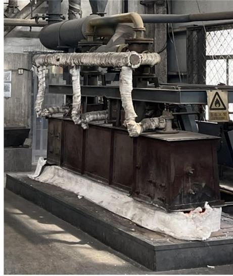
母合金车间燃气加热炉
