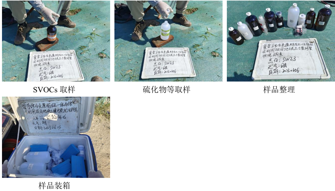
图 5-4 地下水采样全过程照片
