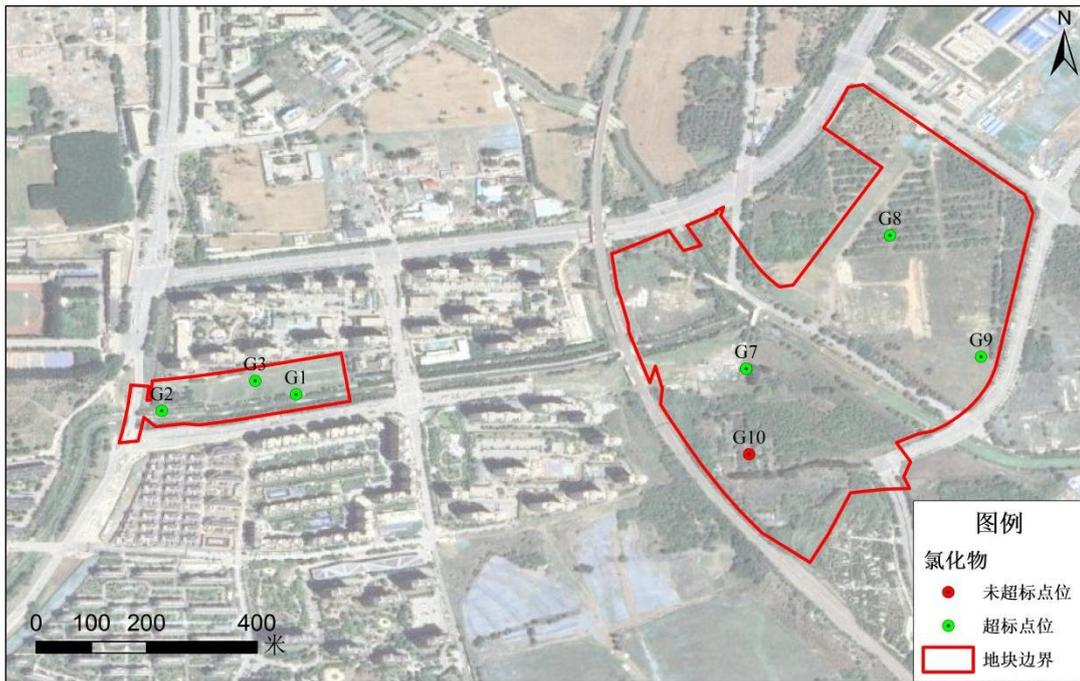
图 7.2-4 地下水氯化物超标点位分布图
