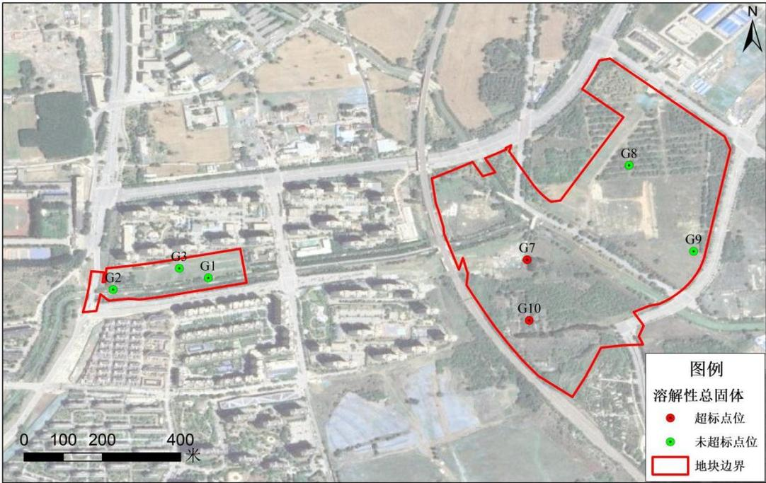
图 7.2-2 地下水溶解性总固体超标点位分布图
