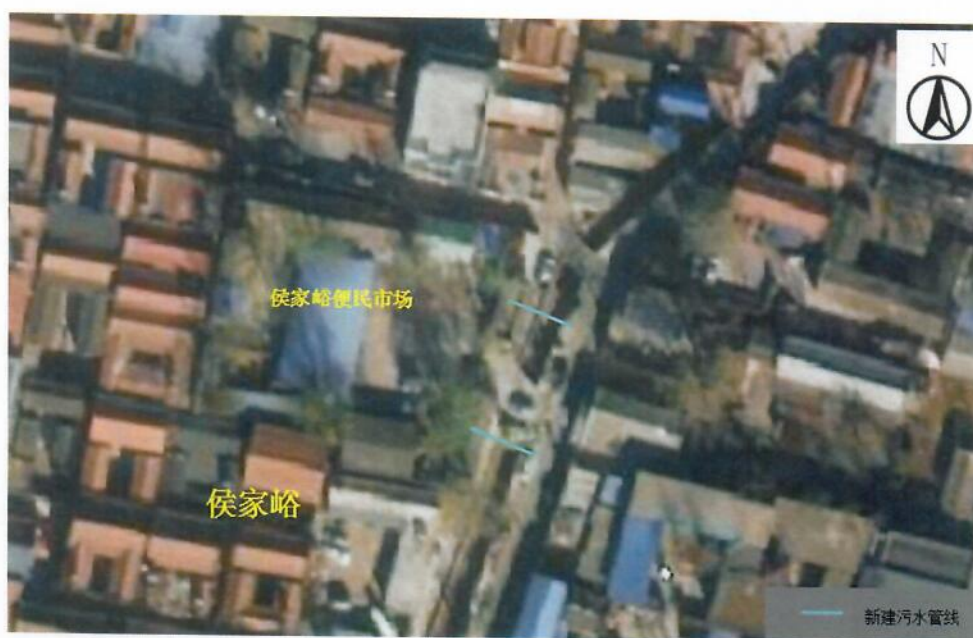
图 9 侯家峪污水管线平面布置图
