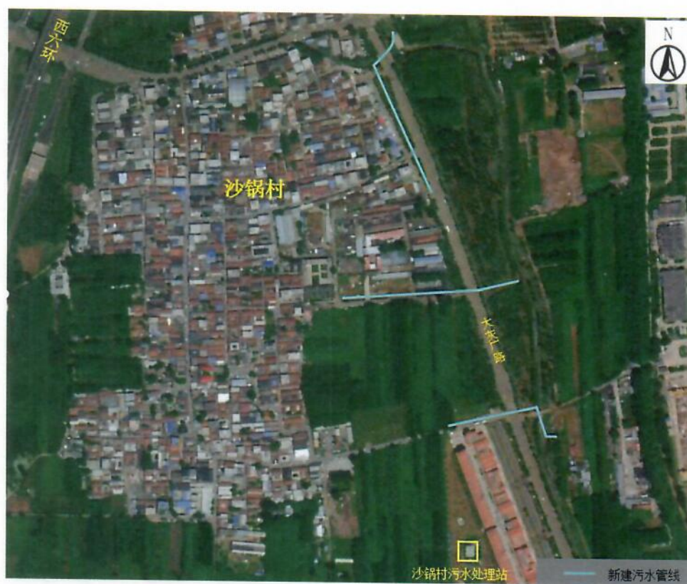
图 8 沙锅村污水管线平面布置图
