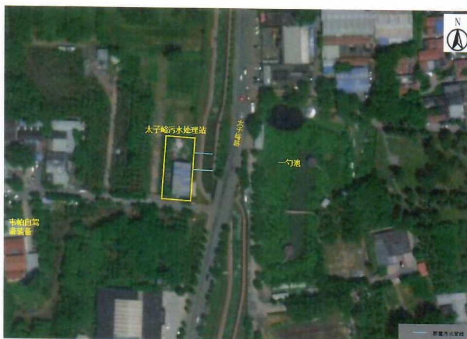
图 12 太子峪村污水管线平面布置图
