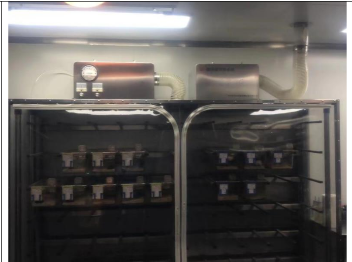
实验鼠鼠笼及其废气收集设施
