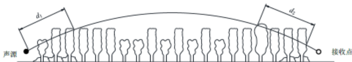
图 4.2-6 通过树和灌木时噪声衰减示意图
