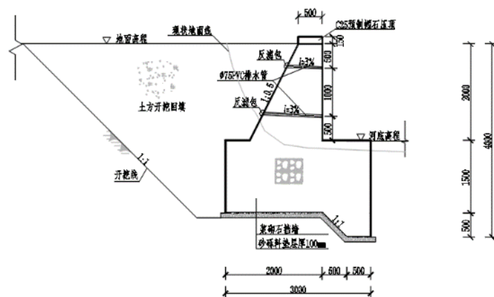
图 2-12 挡墙断面设计图
