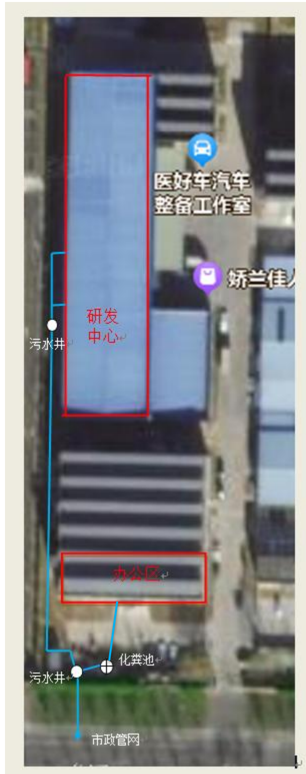
附图 4 项目排水管线图
