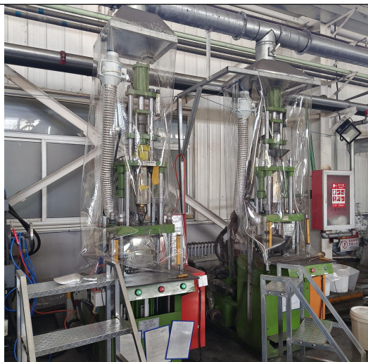
2 台立式注塑机验装置
